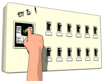
**Point** こんな時に便利なのが、感震ブレーカー。震度5以上の地震の時、自動的に分電盤のブレーカーを落としてくれます。
